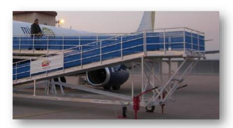
Es una rampa diseñada para servir a aviones A320 y B737. La rampa permite un proceso de embarque sin problemas para todos los pasajeros. Pendiente ajustable y barandales de plataforma con rieles deslizables. No motorizada
